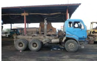
Camion Multibennes, classe de 12 m 3 (châssis : fabriqué au Japon, plateau : fabriqué en Chine)
