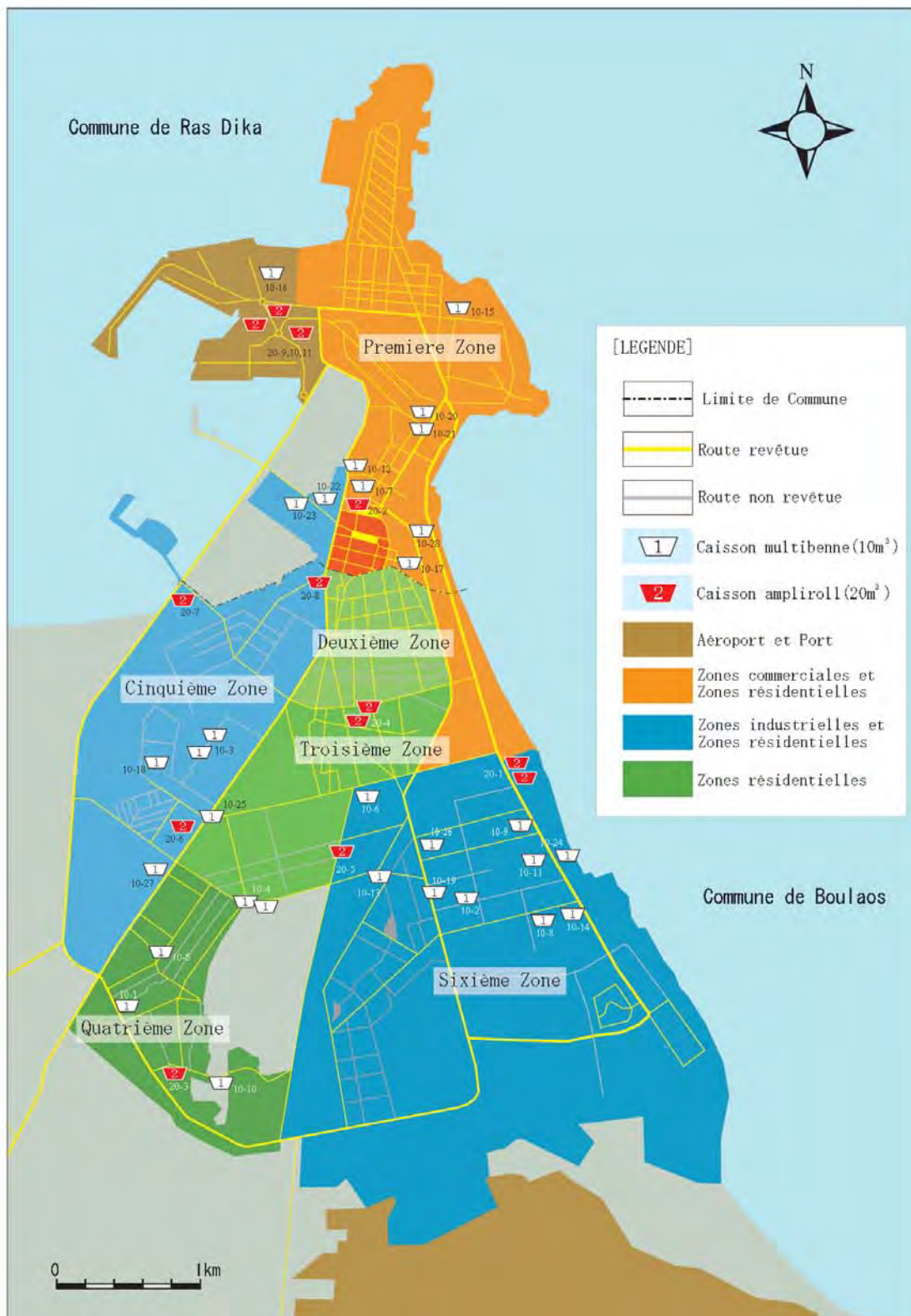
Figure 2-6 Carte des zones de collecte dans la partie est de la ville de Djibouti (Caissons multibennes et ampliroll)
