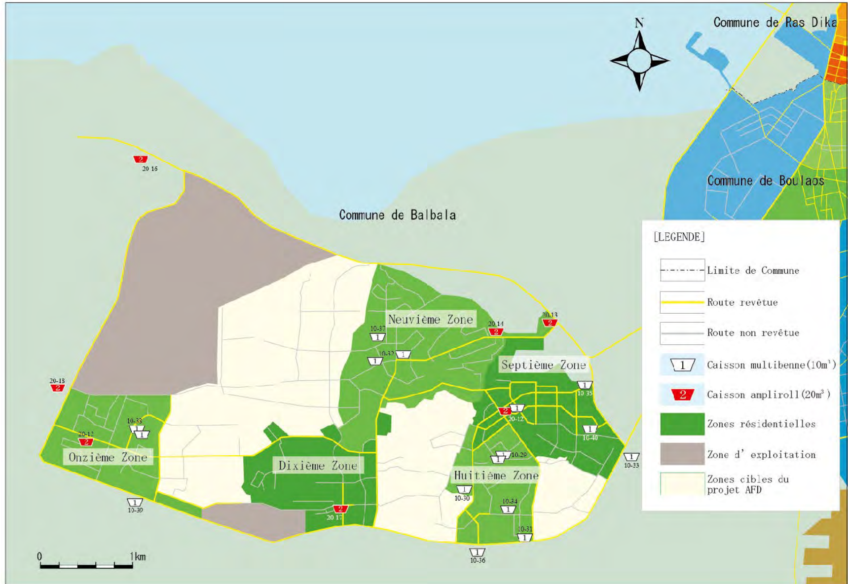
Figure 2-7 Carte des zones de collecte dans la partie ouest de la ville de Djibouti (Caissons multibennes et ampliroll)
