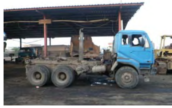
脱着式コンテナ専用車 12m 3 (車体：日本製、架台部：中国製)
