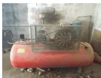
コンプレッサー
