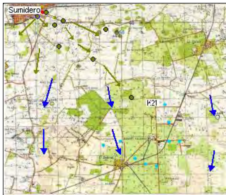
図 4-13 既存給水井周辺で実施された流向調査（EIPHH 資料）
