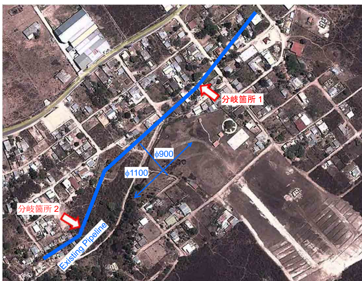
図 3-2.21 新設管ルートの上流分岐箇所
