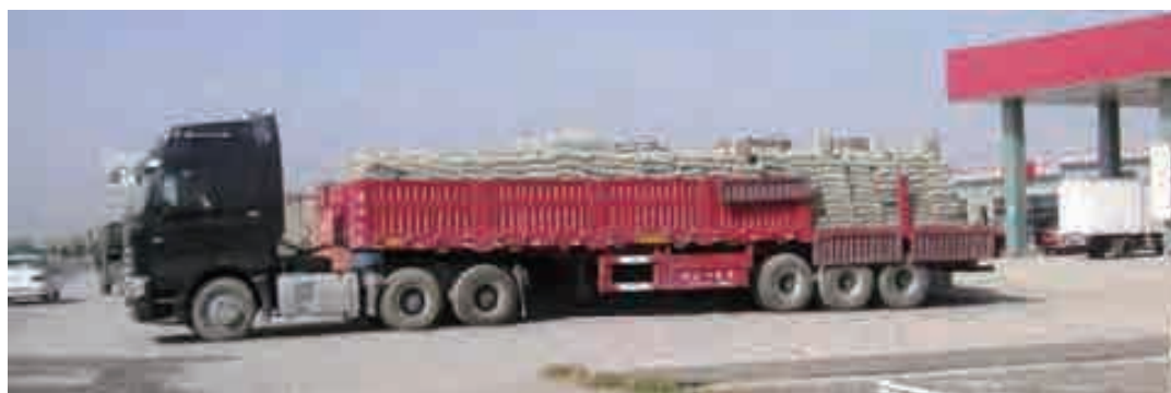
パキスタン産セメントを満載した車両。積載総重量 69.3t、軸重 13.86t。2011 年にドゥスティーニジノピャンジ間で撮影
