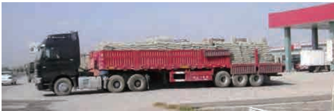
パキスタン産セメントを満載した車両。積載総重量 69.3t、軸重 13.86t。2011年にドゥスティーニジノピヤンジ間で撮影
