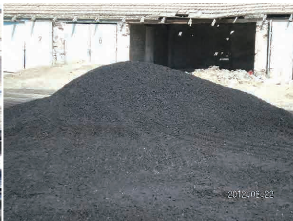
油と骨材をグレーダ等で混合し製造したコールドアスファルト
