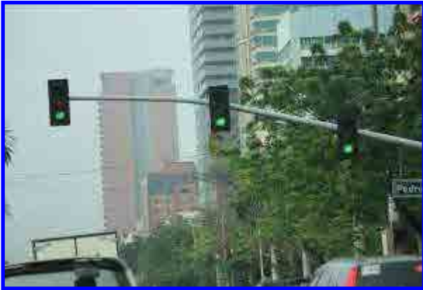
図 2-2-15 車線別の信号機（ロハス通りにて）
