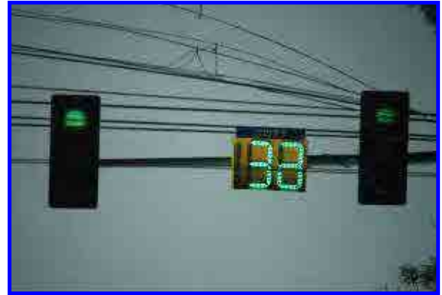
図 2-2-16 赤字間の残余秒数表示機能のある信号機（ロハス通りにて）
