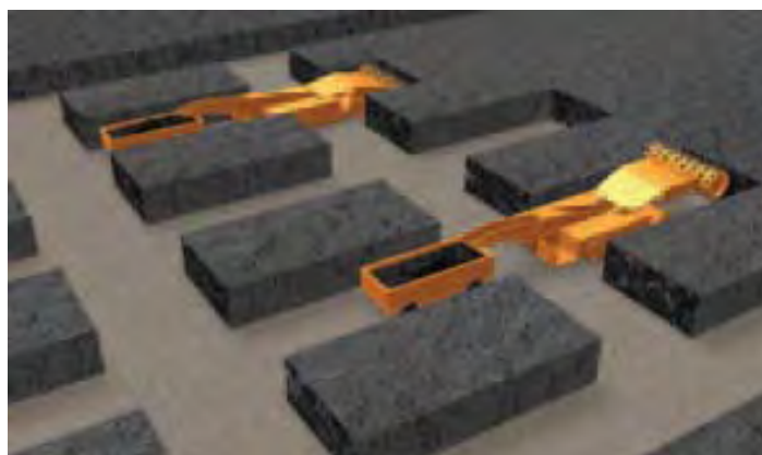
図3.3-3 柱房採炭の概念図
