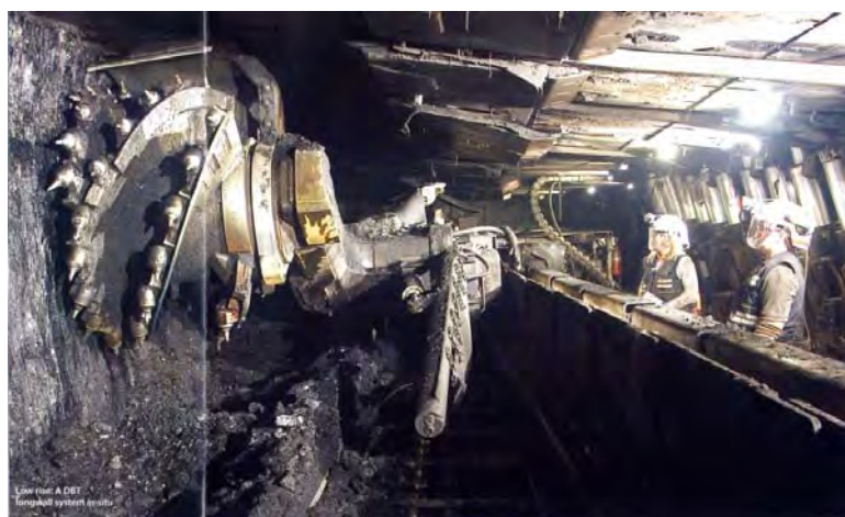
写真3.3-2 完全機械化Longwall採炭の切羽状況例
