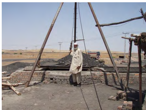
写真 2.3-3 縦坑で石炭を巻き上げる
