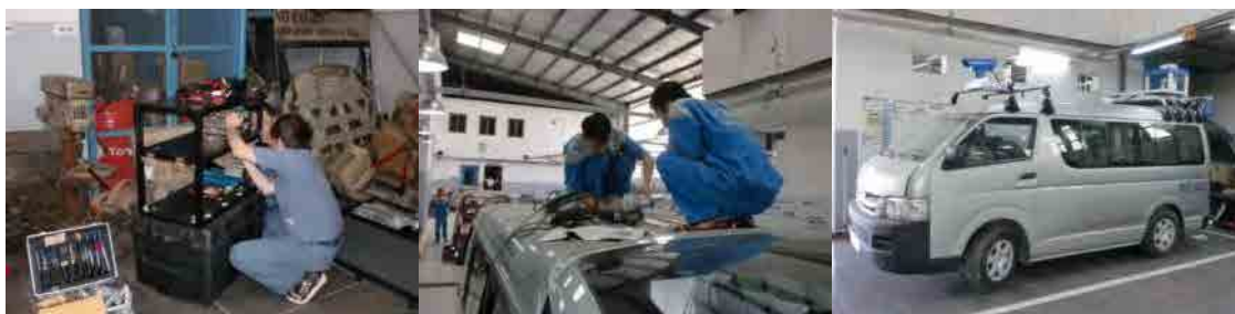
図 11 路面性状調査車のセットアップ
