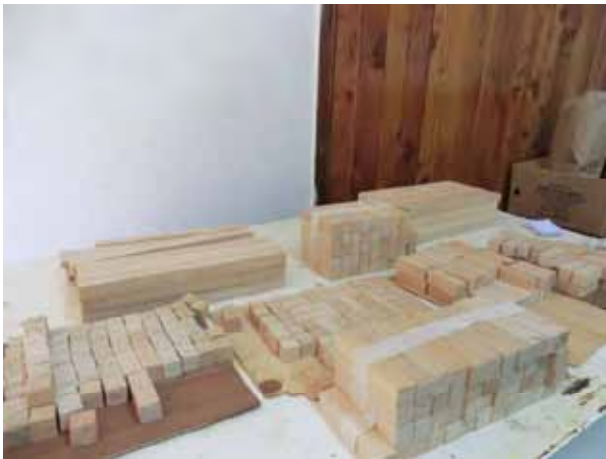
曲げ、圧縮試験が出来る
