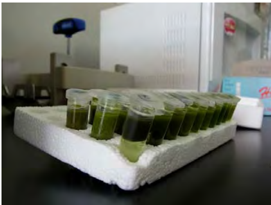
写真: CTAB 法による DNA 抽出の途中サンプル。DNA 溶液の粘性が高すぎて、除去したい細胞の分離がうまくできていない。
