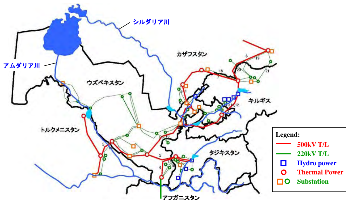
図 1-1-3 中央アジア地域間連系送電線の概要図
