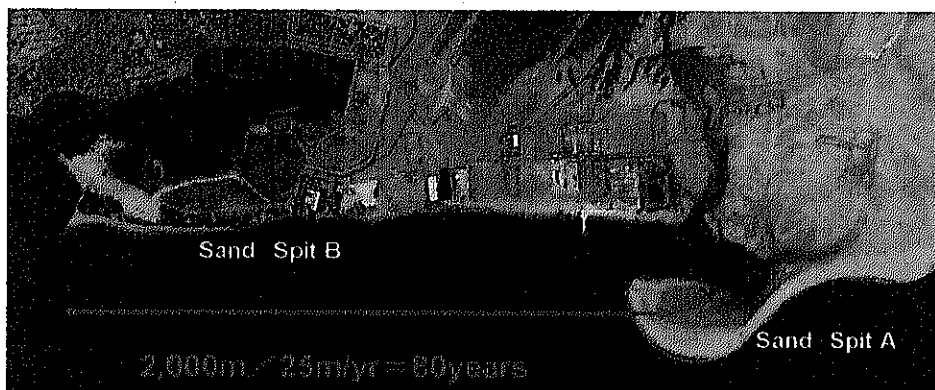
図-2.2.4(5) 砂嘴 (Sand Spit A) の移動 (推定)
