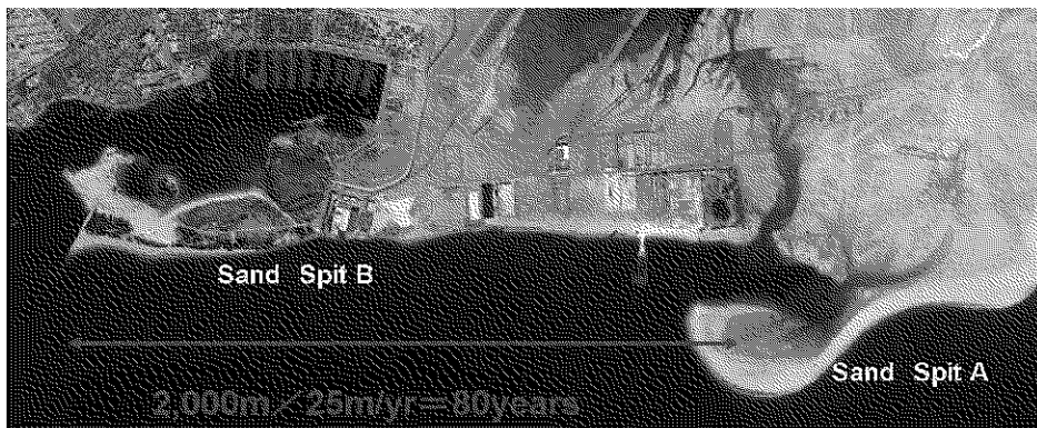
図-2.2.4(5) 砂嘴 (Sand Spit A) の移動 (推定)
