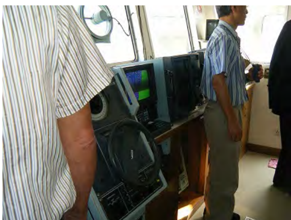
(AMA号) 操舵室内部、操舵スタンド
