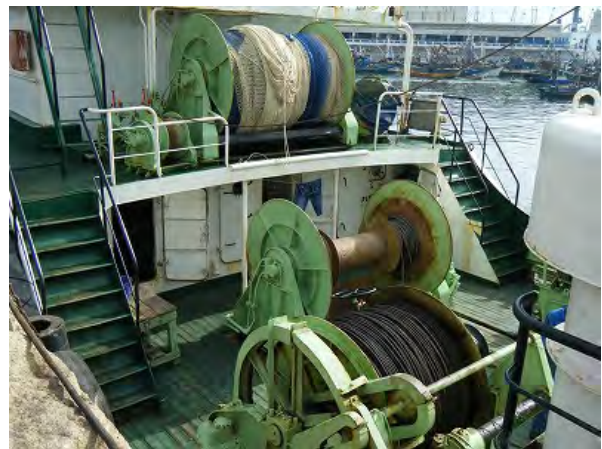
(CAI 号) 中央部ネットウインチ
