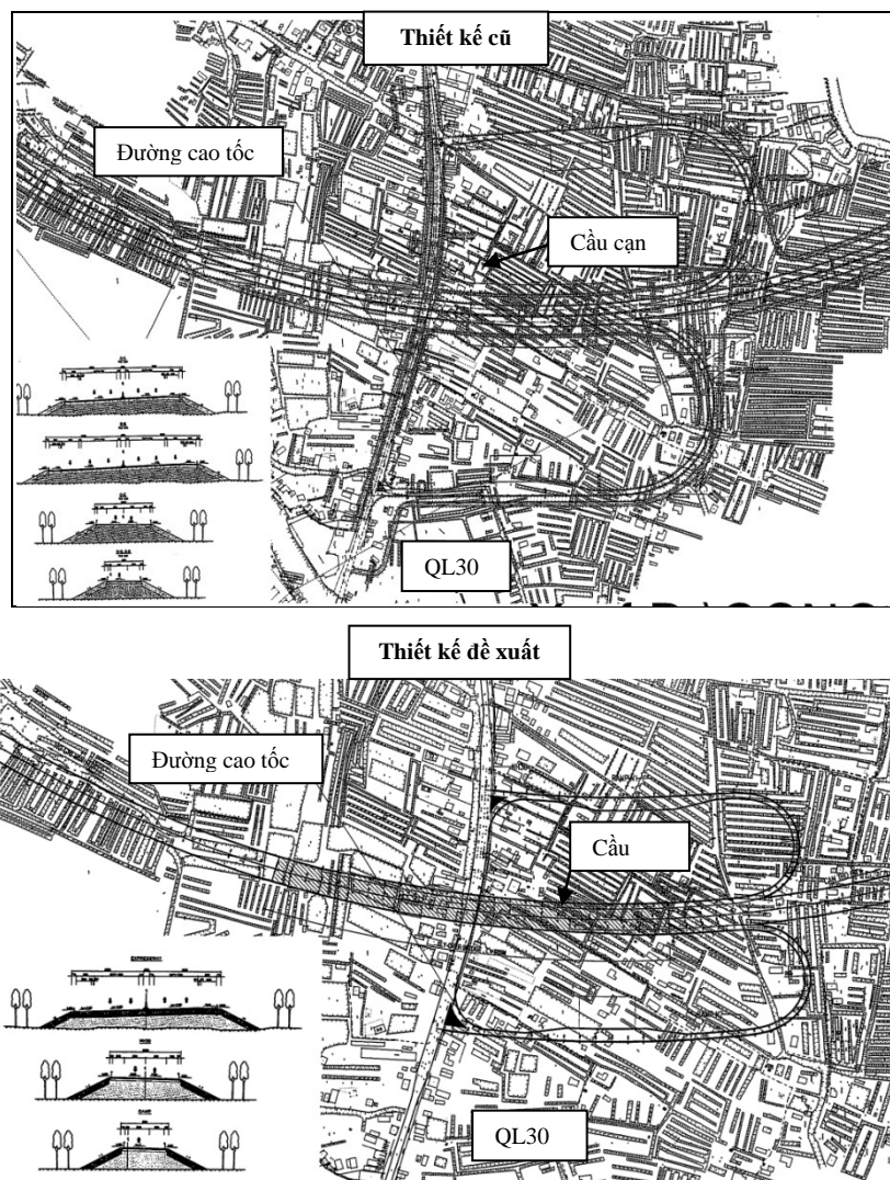
Hình 6.16. Thiết kế ban đầu và thiết kế đề xuất của nút An Thái Trung
