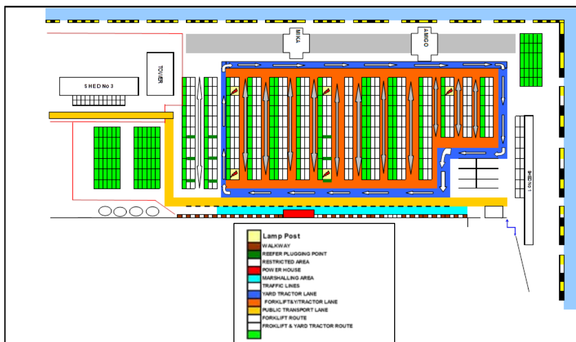
図 4-15 スバ港コンテナターミナルのヤードレイアウト
