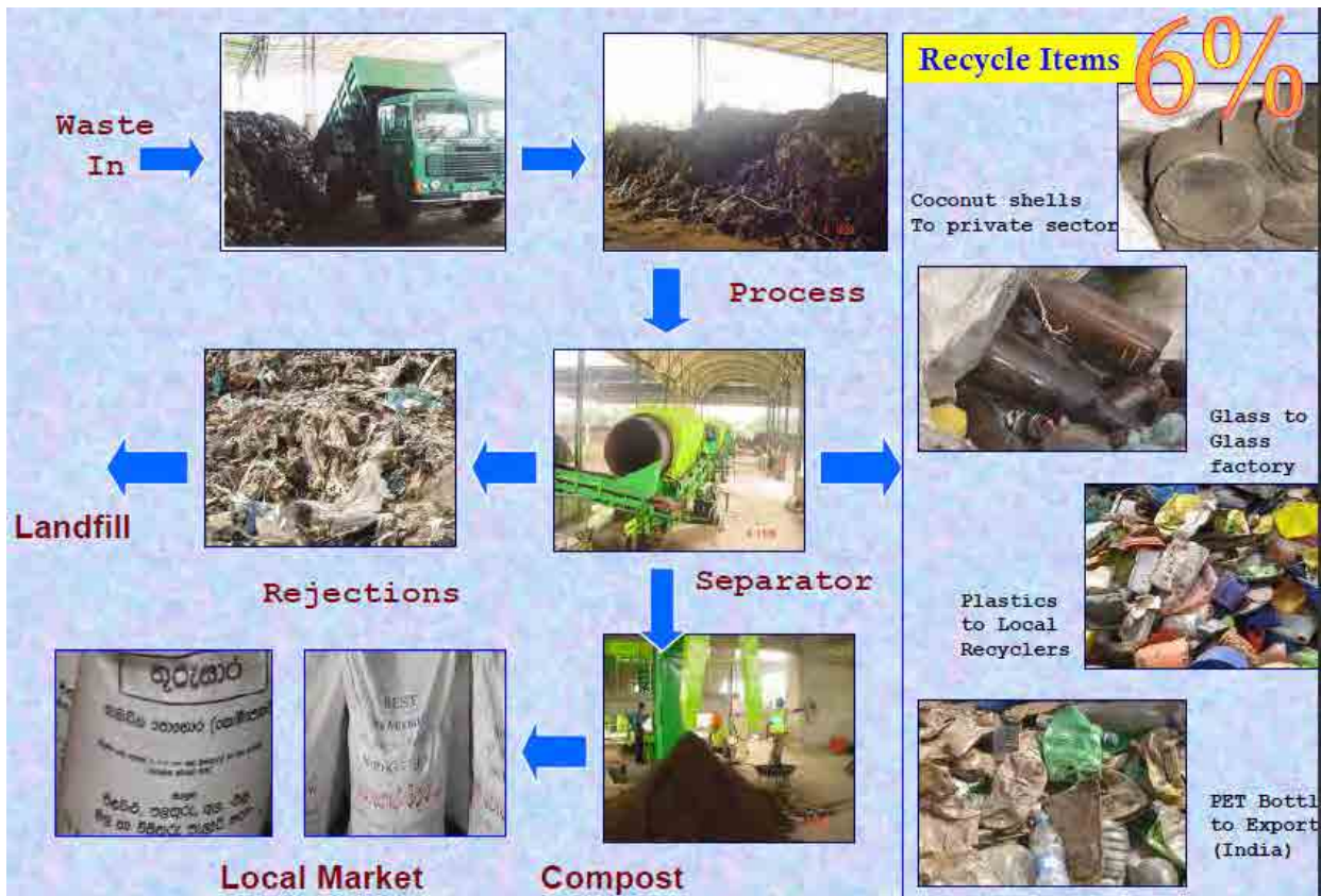
図 24: Bloemendal におけるコンポスト製造プロセス
