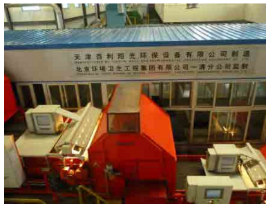
光学センサーによりプラスチックごみを分別するドイツ製の機械を導入している。
