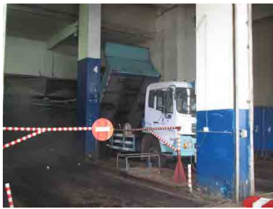
プラットフォーム内で収集車がごみを下している様子。
