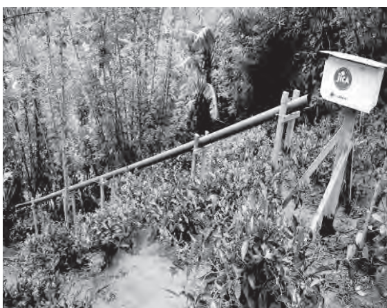
写真 23 設置した地上伸縮計
