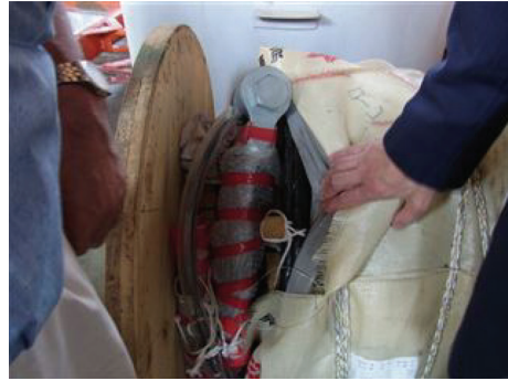
ブイのセンサーを取り付けるワイヤー
