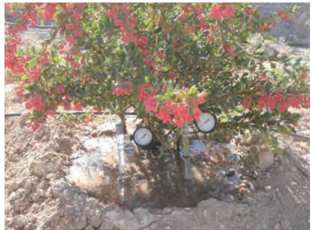
نصب مکش سنج ها (تانسیومتر: Tensiometer) برای زرشک
