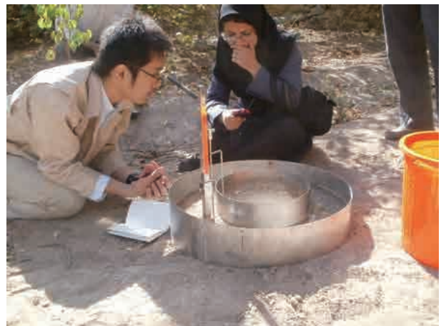
浸透能試験計測
