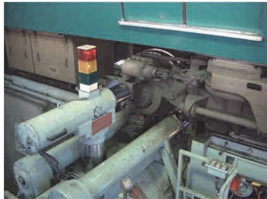
Nguồn: Đoàn nghiên cứu chụp Hình 3.5.4 Máy tiện xoay bánh xe dạng dưới sàn (máy tiện)
