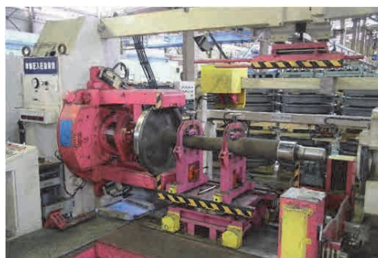
Nguồn: Đoàn nghiên cứu chụp Hình 3.5.7 Hệ thống nạp-xả áp lực bánh xe
