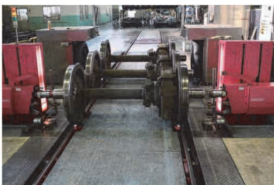
Nguồn: Đoàn nghiên cứu chụp Hình 3.5.6 Hệ thống nhận biết vết xước trục bánh xe bằng tần sóng tự động
