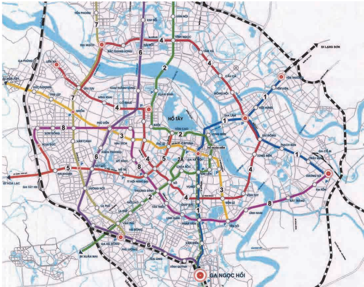
Nguồn: Quy hoạch giao thông Hà Nội cho đến năm 2030 (Quyết định số 1259/QĐ-TTg) Hình 1.2.9 Bản đồ quy hoạch mạng lưới tàu điện ngầm, đường sắt đô thị Hà Nội
