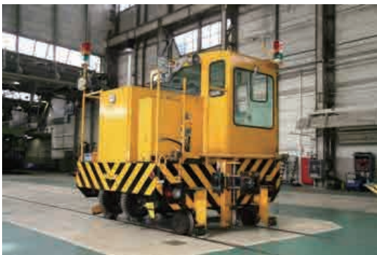
出典：調査団撮影 図 3.5.8 車両牽引車
