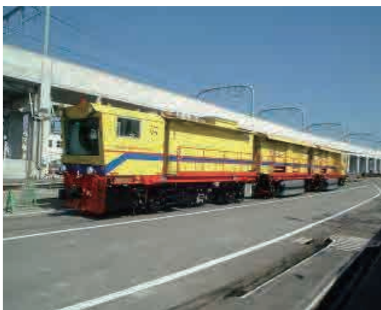
出典：調査団撮影 図 3.5.12 レール削正車
