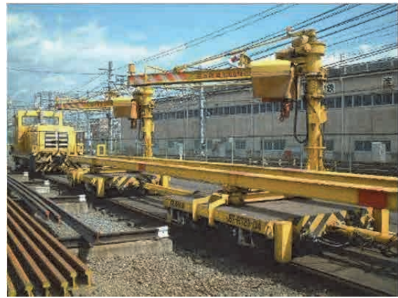
出典：調査団撮影 図 3.5.13 レール・PC 運搬車
