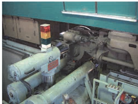
出典：調査団撮影 図 3.5.4 床下形車輪旋盤（旋削盤）
