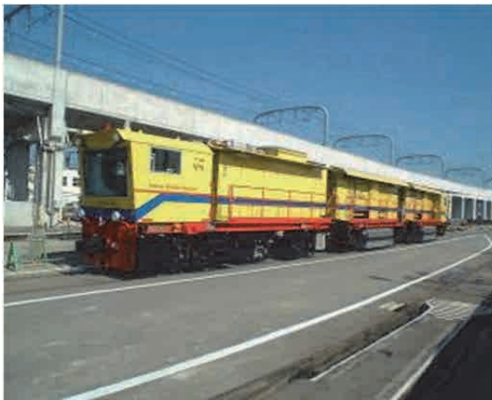
出典：調査団撮影 図 3.5.12 レール削正車
