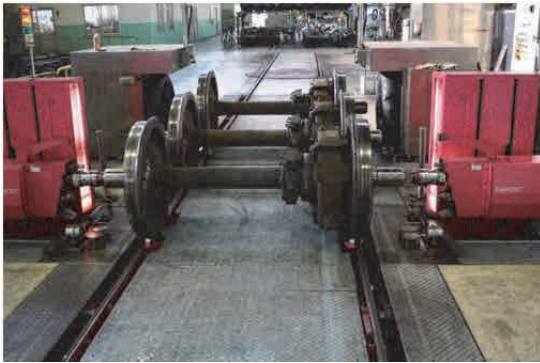
出典：調査団撮影 図 3.5.6 輪軸自動超音波探傷装置
