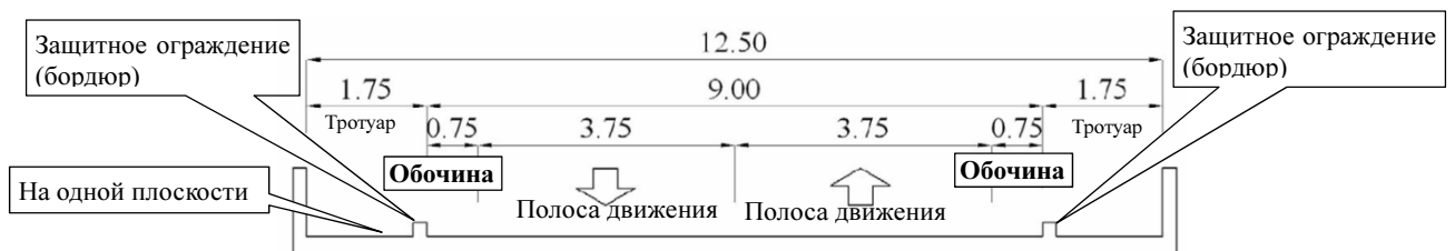
Рис. 2-2-4. Структура поперечного профиля дороги, применяемая в ранее реализованном проекте безвозмездной помощи
