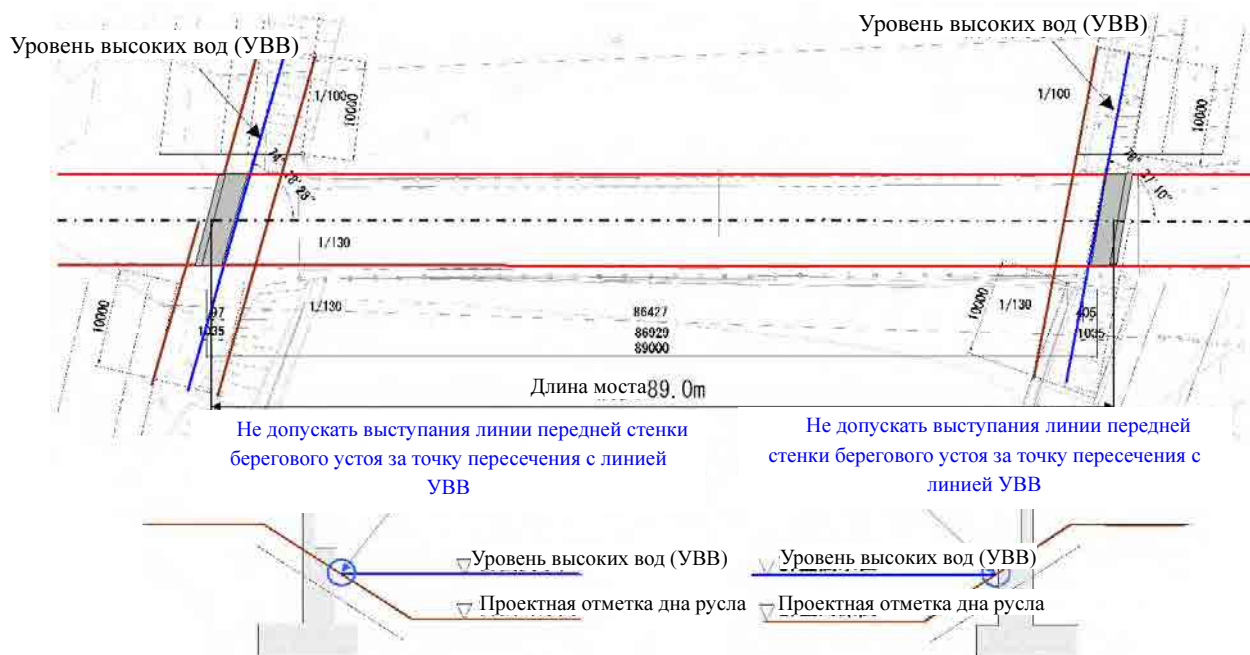
Рис. 2-2-16 Контрольные точки при планировании нового моста
