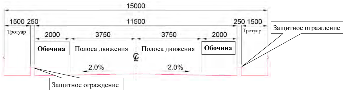
Рис. 2-2-2. Предложенная структура поперечного профиля проезжей части моста
