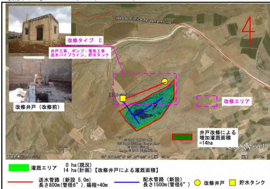
図 3-1-7 (6/9) 9 井戸施設の灌漑エリアおよび改修タイプ (No. 8 井戸施設)
