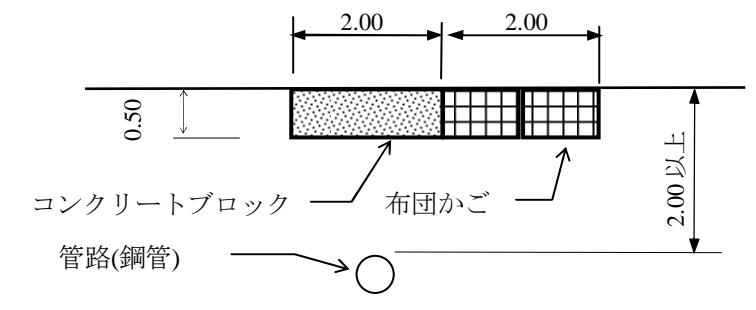
図 3-1-15 ワジ横断工標準断面図
