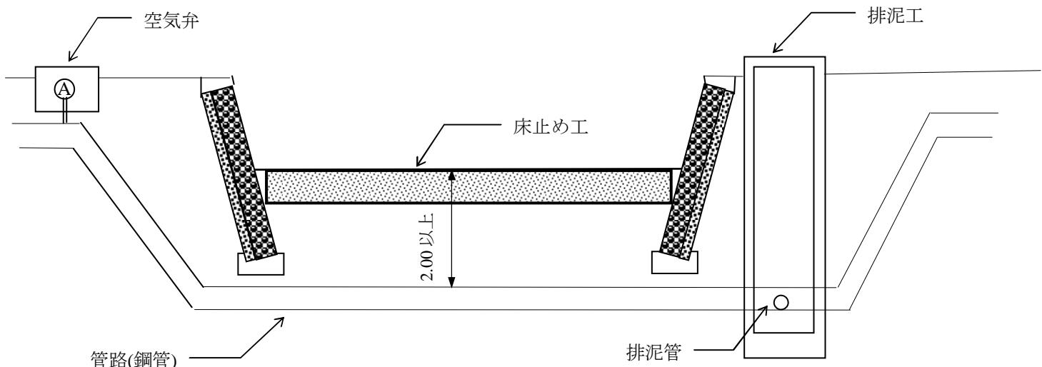
図 3-1-16 ワジ横断工標準断縦断図
