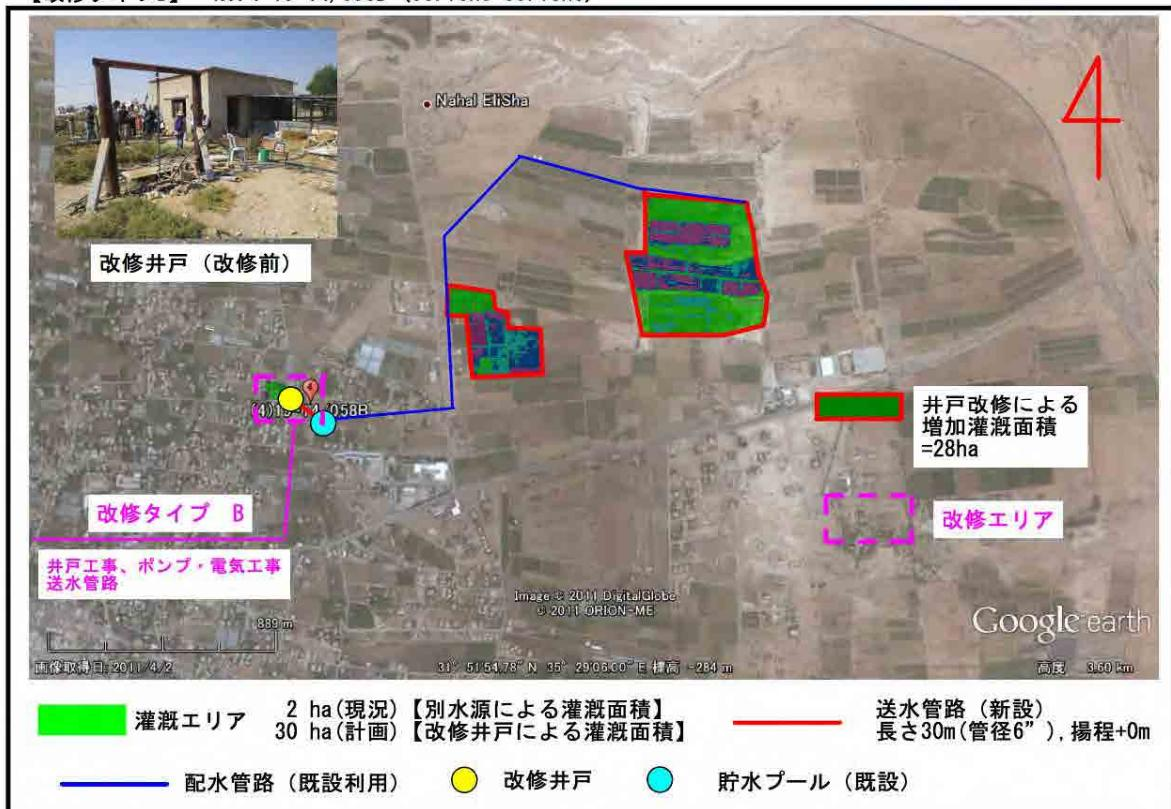
図 3-1-7 (3/9) 9 井戸施設の灌漑エリアおよび改修タイプ (No. 4 井戸施設)
