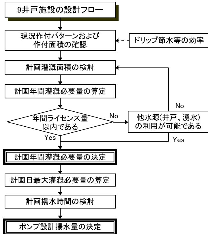
図3-1-8 9井戸施設のポンプ設計揚水量の算定フロー
