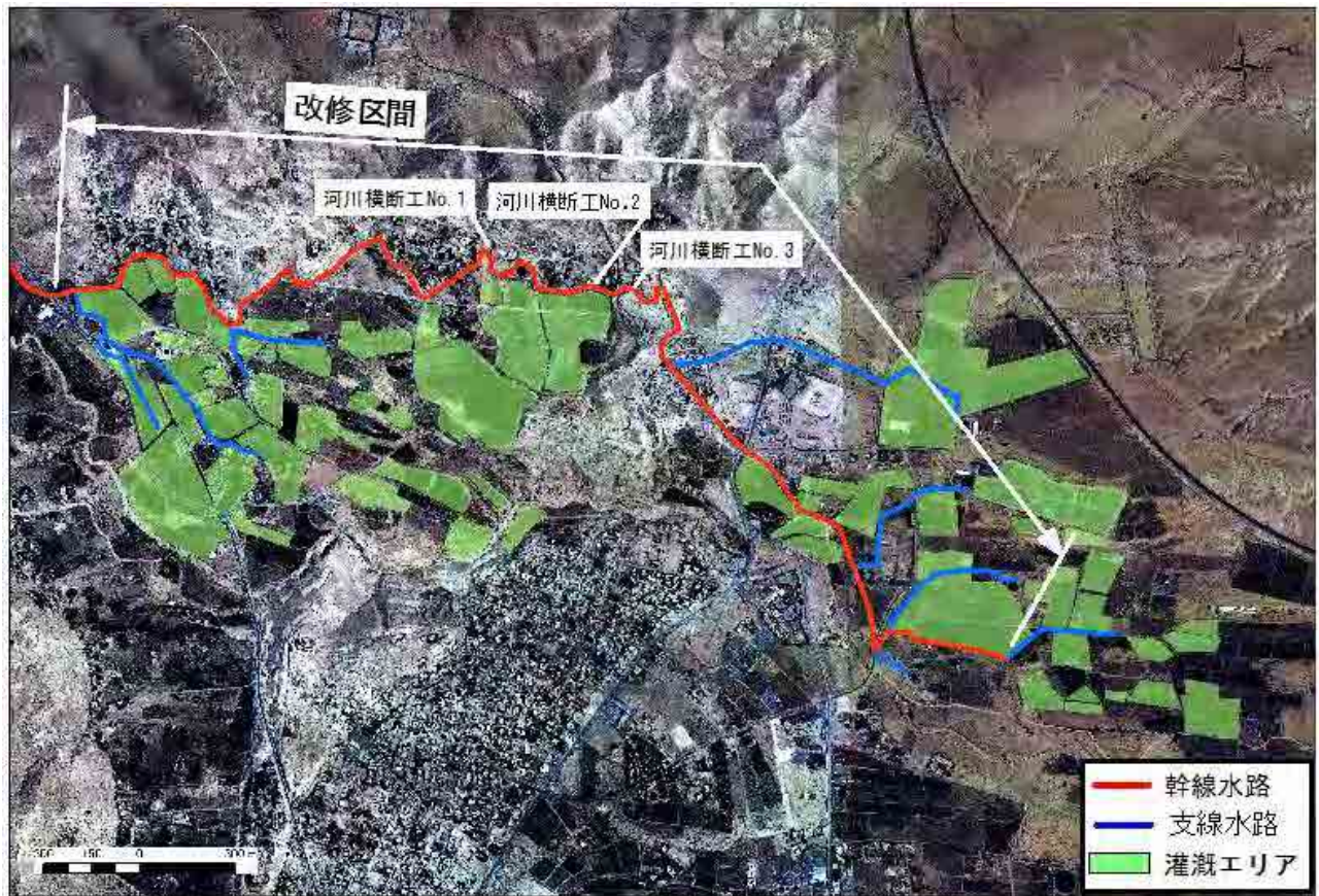
図 3-1-14 ヌエイマ湧水用水路計画平面
