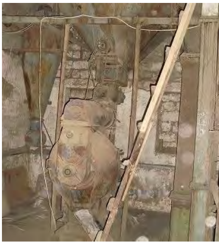
写真-9 : Criuleni 県 Baltata 村 民間企業の旧式ペレット製造設備の造粒機。電力消費量が大きく、非効率。造粒機と破碎機を同時に使用できない。
