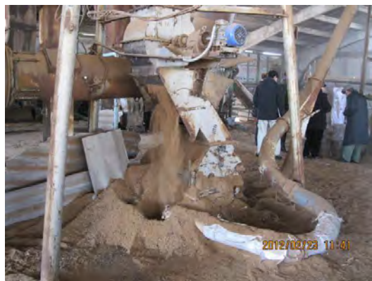
写真-11 : Ialoveni 県 Sociteni 村 民間企業で稼働中の非常に古いペレット製造設備。二次破碎されたペレット原料はこの後造粒機へ送られている。
