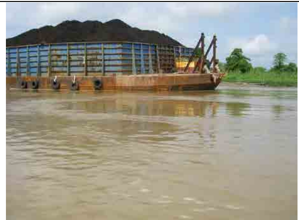
移動中に遭遇した砂利運搬船② 喫水線を見る限り過積載と思われる船が多いこ とは安全面の課題であると思われる。
