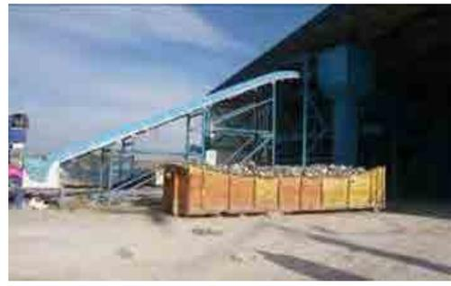
写真-2 ジェニン最終処分場2：収集された資源ごみについてはベルトコンベアに乗せられて、手作業にて分別される。
