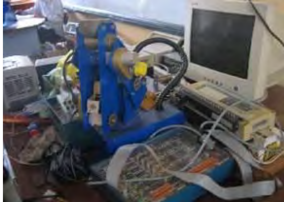
写真－5： 電気エネルギー工学科の自動制御実験用に自作したロボット。
