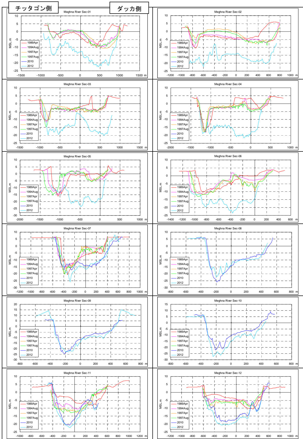
図 5.3.2 メグナ川架橋地点周辺の横断形状の経年変化
