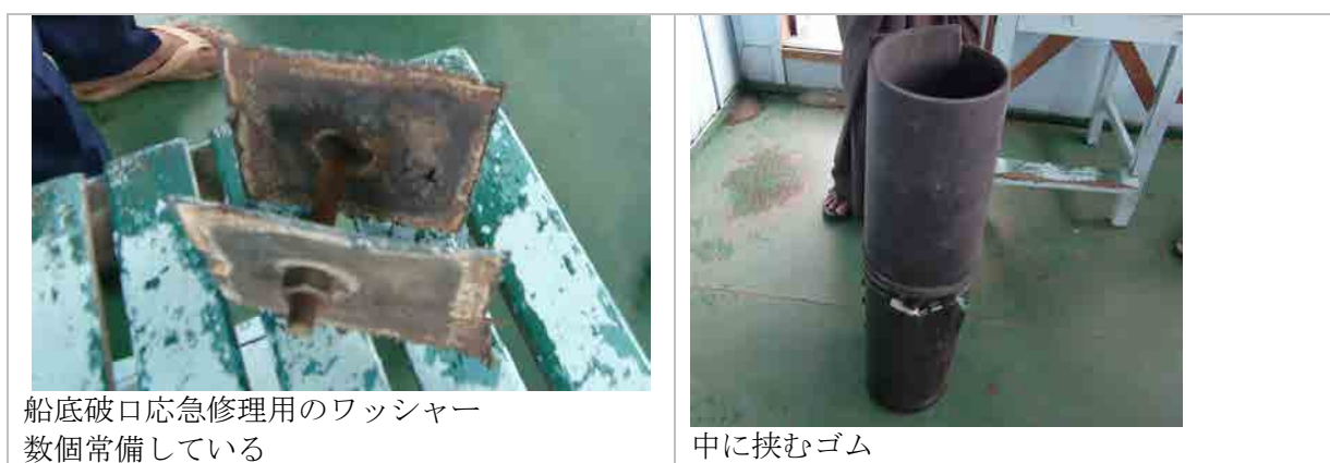
図 2-12 船底破口修理キット
