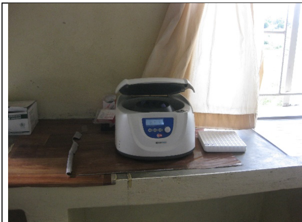
チャンボリ保健センター ラボ 遠心分離機 血液の成分分離に用いている。機材の状態は良く、今後5年以上継続使用が可能な状況である。
