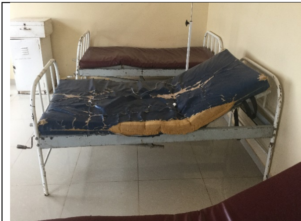
新ムシリ保健センター 患者用ベッド 老朽化したベッド本体は錆び、マットレスは側生地の擦り切れによる破損が見られる。
