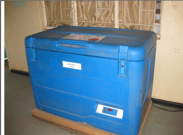
チャンボリ保健センター ワクチン冷蔵庫 クーラーボックスではなく、温度調整や低温保管(2~8度)が可能なタイプ。
