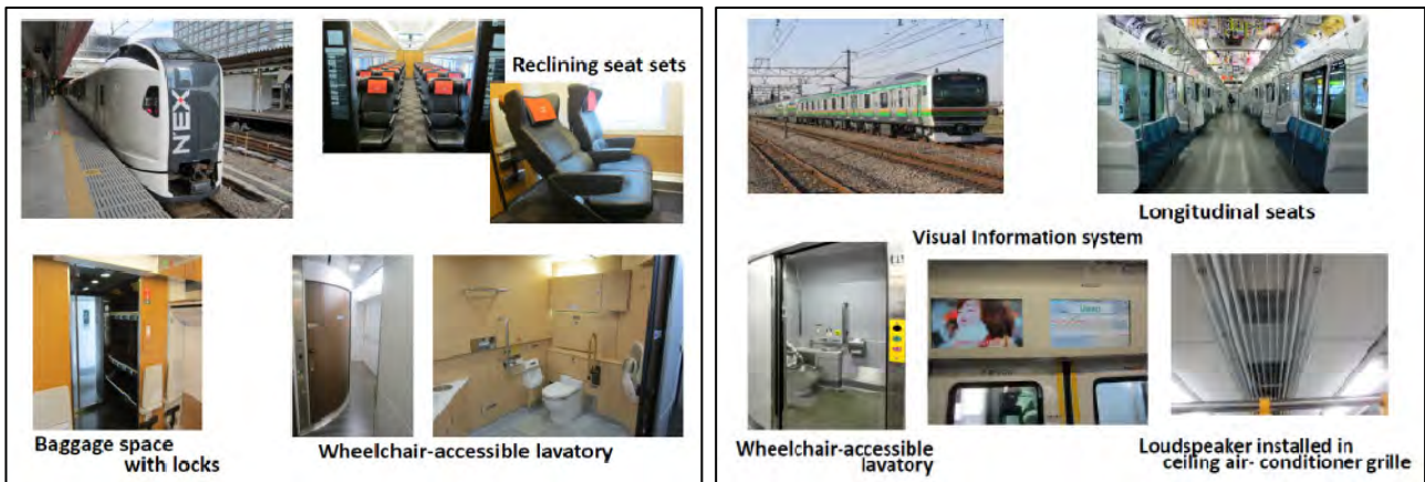
図 7-1 通勤列車、空港アクセス特急の設備の例 (JR 東日本)
