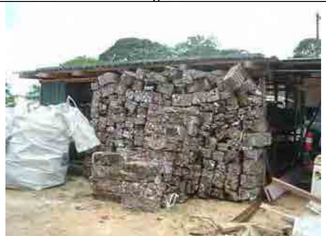
GIO Recycling (Family Owned Business) 飲料缶等の有価物は圧縮機でプレスされ出荷される。
