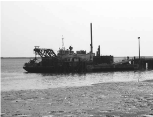
写真 3.3.24 係留されているカッターサクシオン 浚渫船
