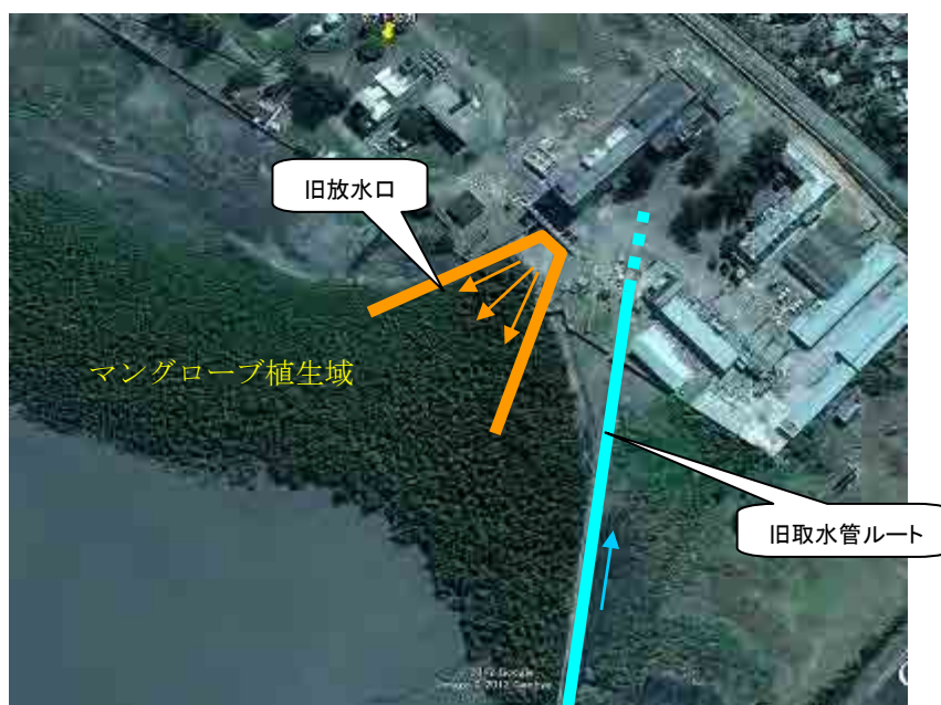
図4.2-7 旧石炭火力発電所の放水位置
