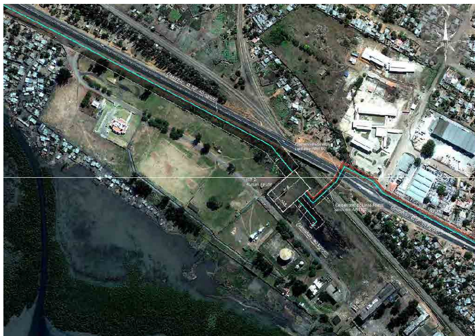
図6.2-8 CTM (マップト) 発電所付近のパイプラインルート (緑色のライン) 及び発電所内の減圧ステーション位置図
