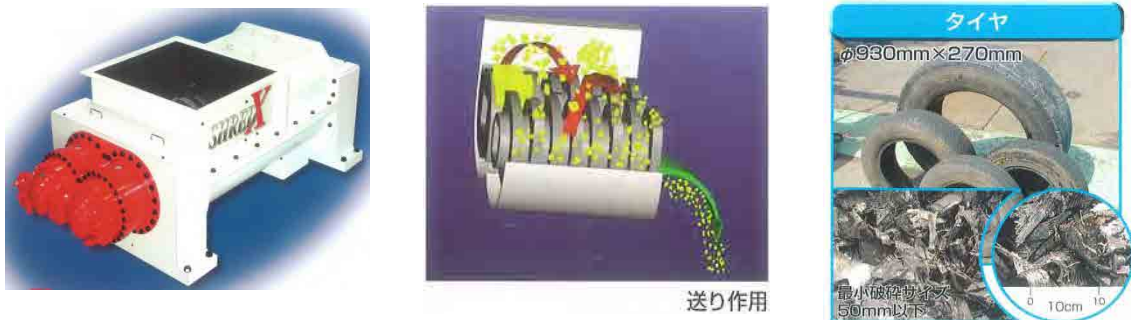
图 7-25 废轮胎的粉碎机的案例 16
