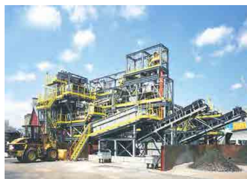
図 7-65 オンサイト型土壤洗浄プラント 56
