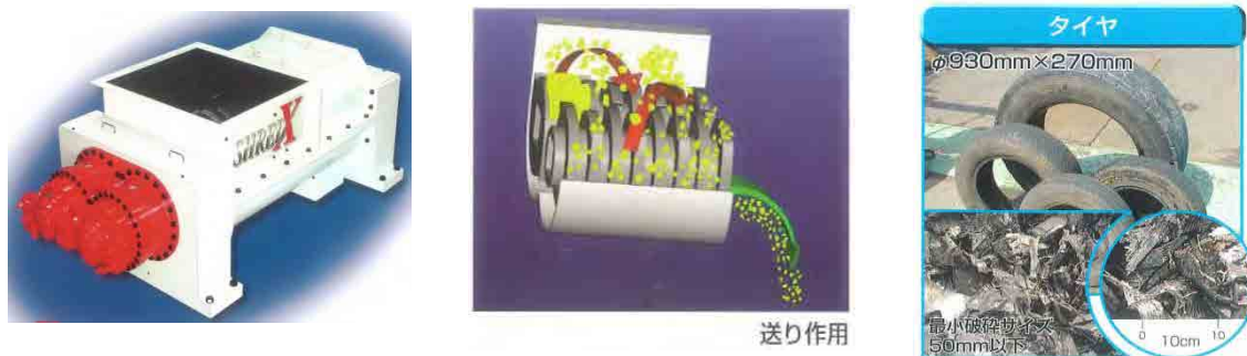
図 7-25 廃タイヤの破碎機の例 33
