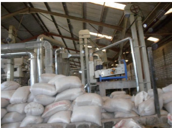
写真－５：MRGMの精米所 精米機が２基設置されており、約3t／時間と約2t／時間の性能である。いずれも稼働する。
