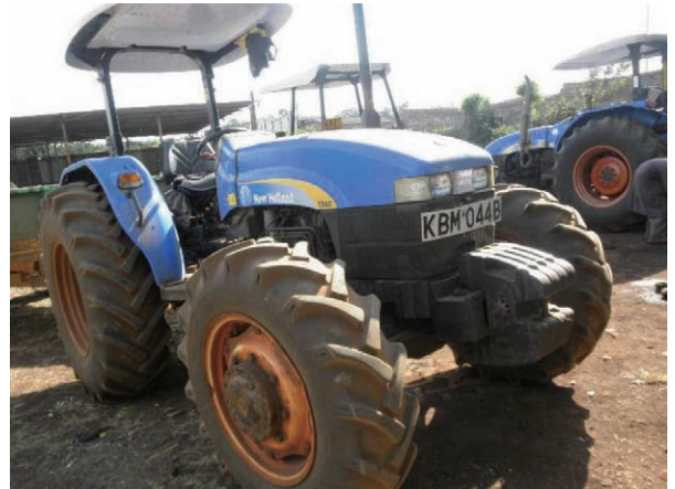
写真－４：MRGMの農業機械 MRGMが保有するトラクター。New Holland製、型式TD80、80HPの仕様である。稼働する。
