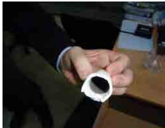
円筒ろ紙に採取したダスト、ろ紙内部にダストが付着して灰色になっている
