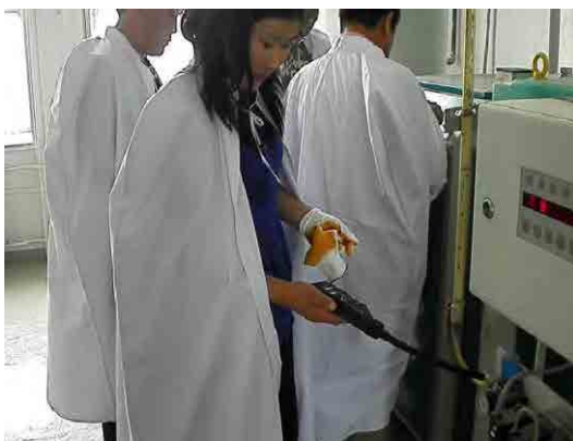
図-4-1: 超音波漏洩検知器による圧縮空気の漏洩チェック
