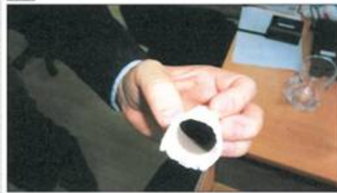
汚染ろ紙に採取したダスト。ろ紙内部にダストが付着して茶色になっている
